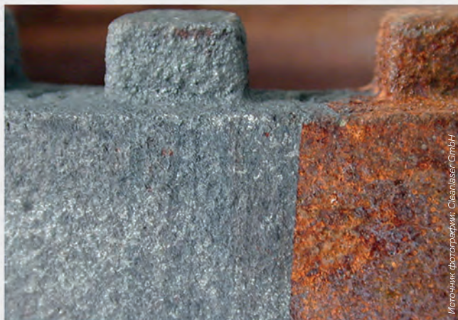
Очистка деталей от ржавчины
